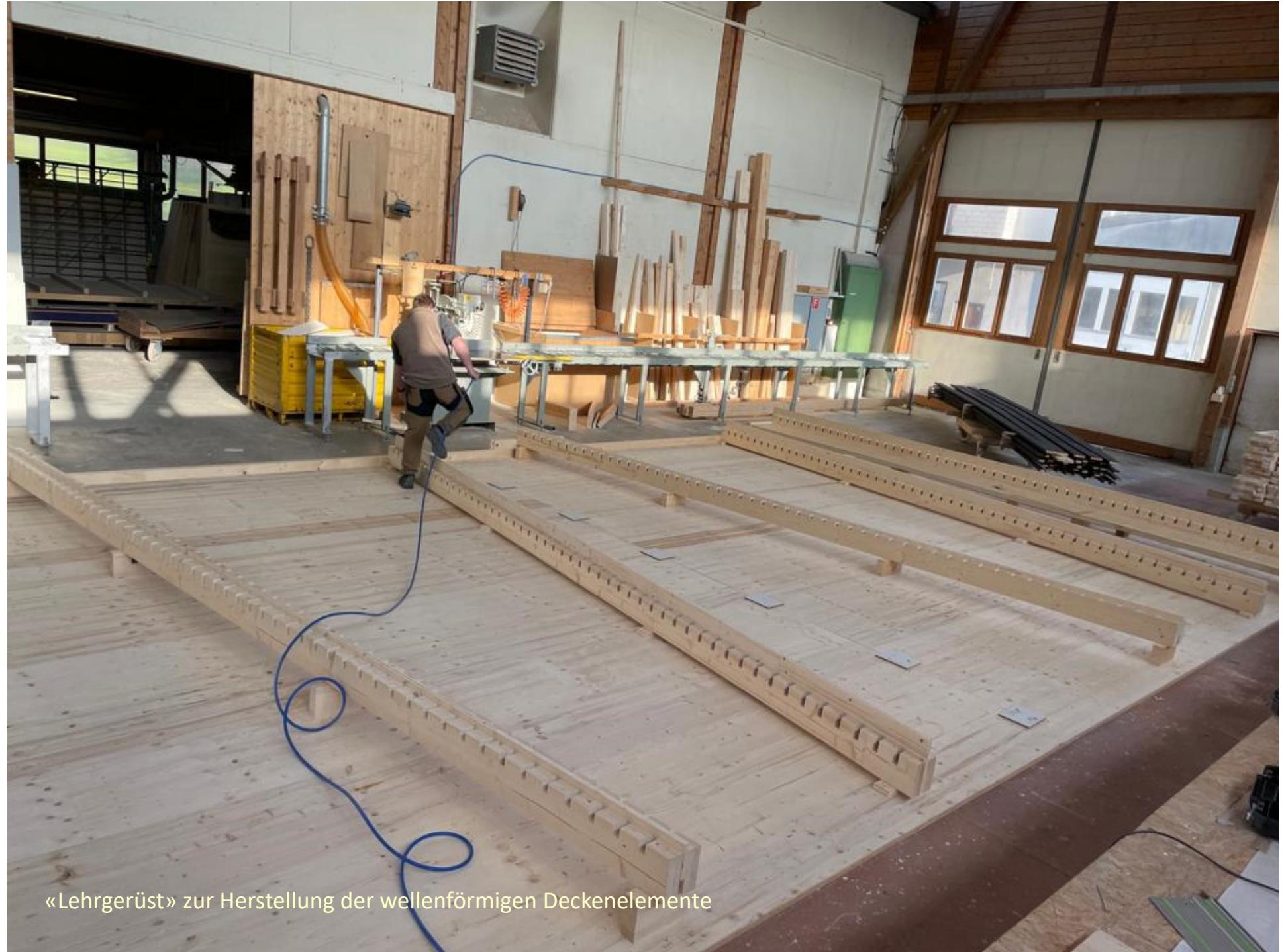
«Lehrgerüst» zur Herstellung der wellenförmigen Deckenelemente
