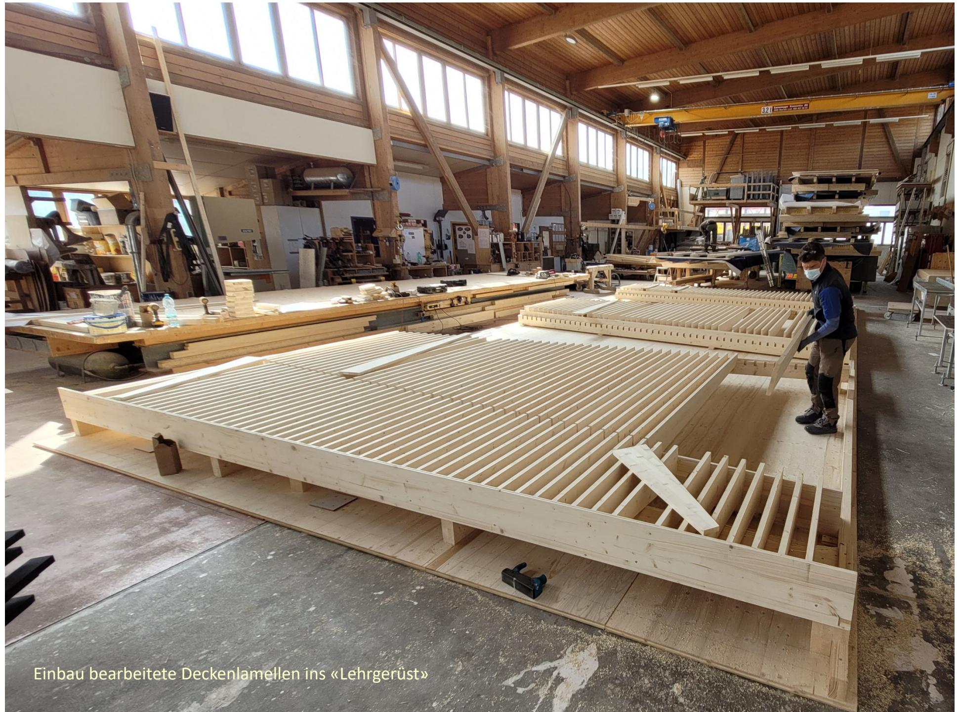
Einbau bearbeitete Deckenlamellen ins «Lehrgerüst»
